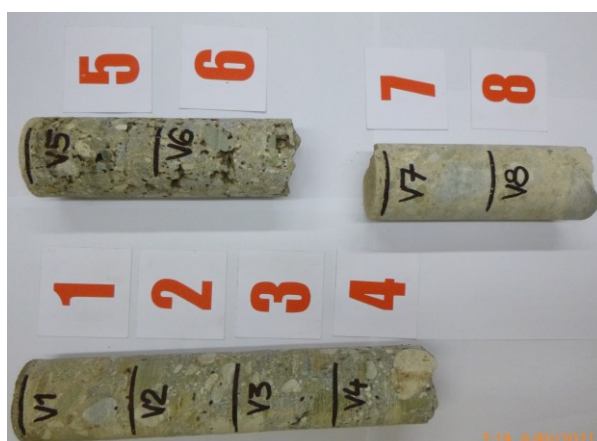
Foto 3.1: Dokumentace vývrtů pro destruktivní zkoušky pevnosti v tlaku betonu opěr
