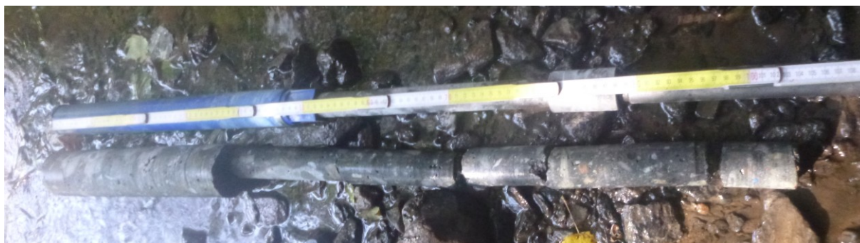
Foto 3.2: Dokumentace vývrtu ke zjištění tloušťky opěry - sonda SK3
